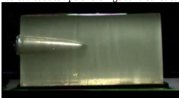
Figura 2 – Demonstração experimental da formação da cavidade temporária em gelatina balística
